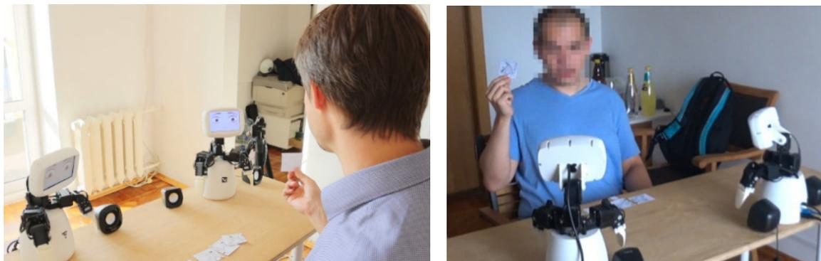
*Рис. 1. Экспериментальная ситуация: робот отвечает взглядом на взгляд человека*
