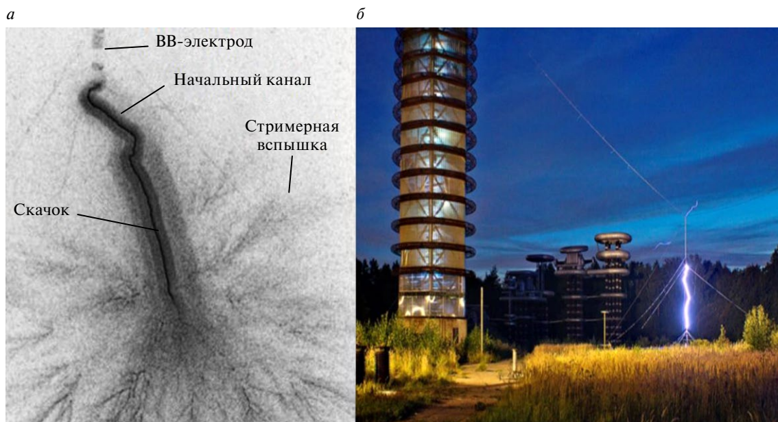
Изображение стримерной вспышки скачка положительного лидера длинной искры (а); генератор импульсных напряжений 6 МВ, моделирующий молниевую вспышку (б)
