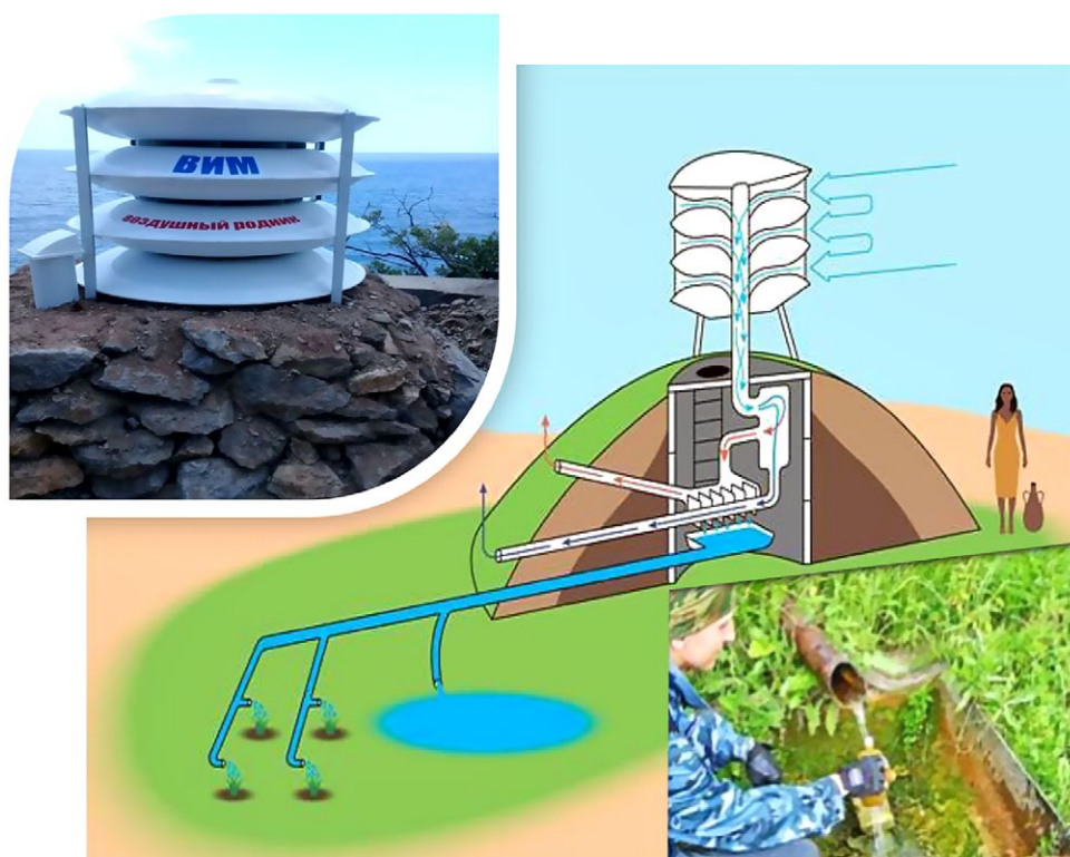
Установка и технологическая схема получения воды из атмосферного воздушного потока
